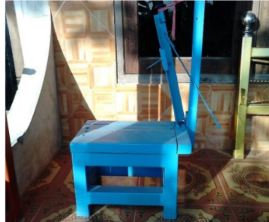
Gambar 2. Alat Plong (Pelubang) Seng/Kaleng Mitra 1 dan Mitra 2
