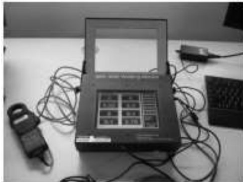
Gambar 4.7 Alat pengukur siklus thermal.
