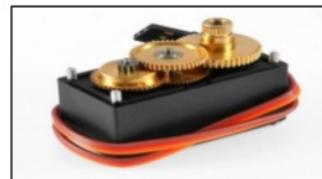
Gambar 2.5 Motor DC dilengkapi dengan reducer speed.[6]
