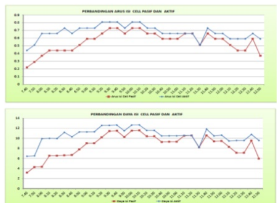
Gambar 4.4 Grafik arus solar cell pasif dengan solar cell aktif
