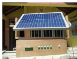
Gambar 4.5 Posisi Solar Tracker pada jam 12.00
