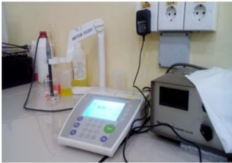
Gambar 8. Alat Pengujian pH Meter pada Keempat Sampel Air Tanah
