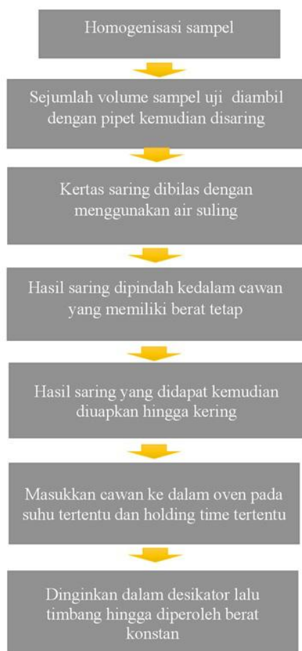
Gambar 6. Diagram Blok Tahapan Umum TDS
