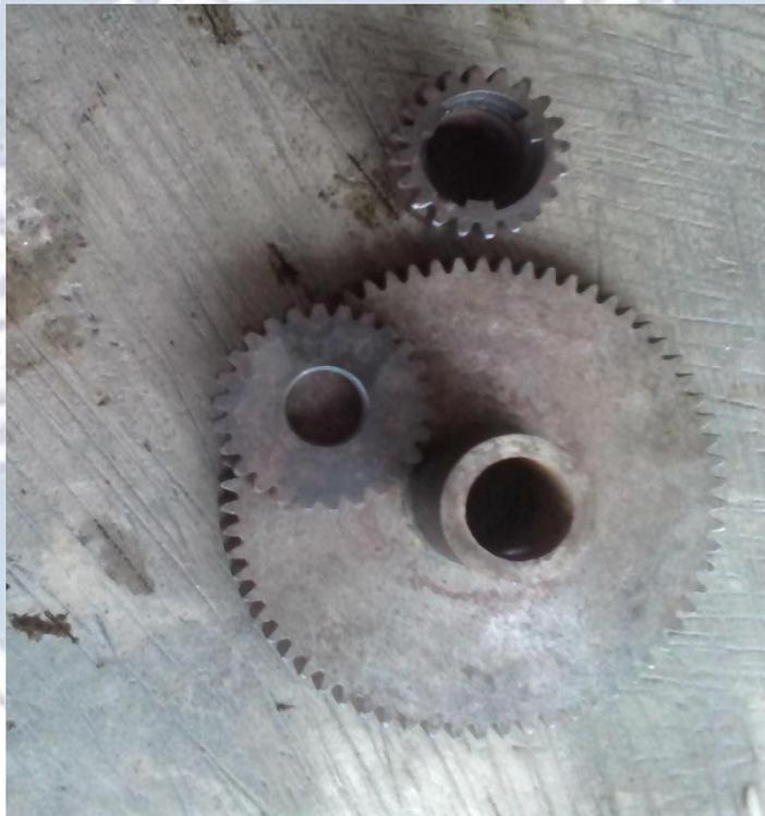
**Gambar 3.3** Roda gigi lurus (*Spur gear*)
