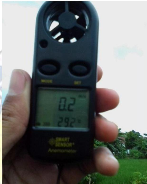
**Gambar 3.6** Alat ukur anemometer
