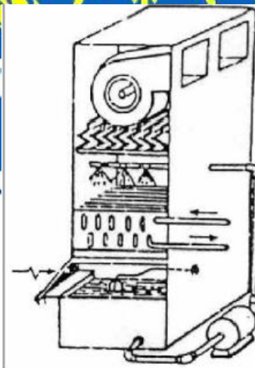
Gambar 2.10. Kondensor Berpendinginan Air dan Udara (Hartoyo, 2015)
