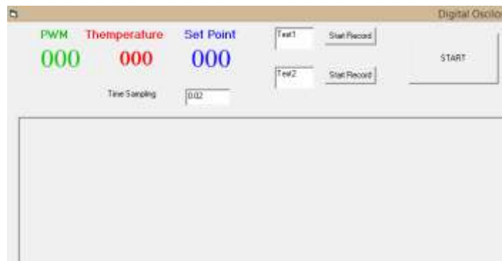
Gambar 3.10 Tampilan Visual Basic yang digunakan untuk mengamati respon PID.
