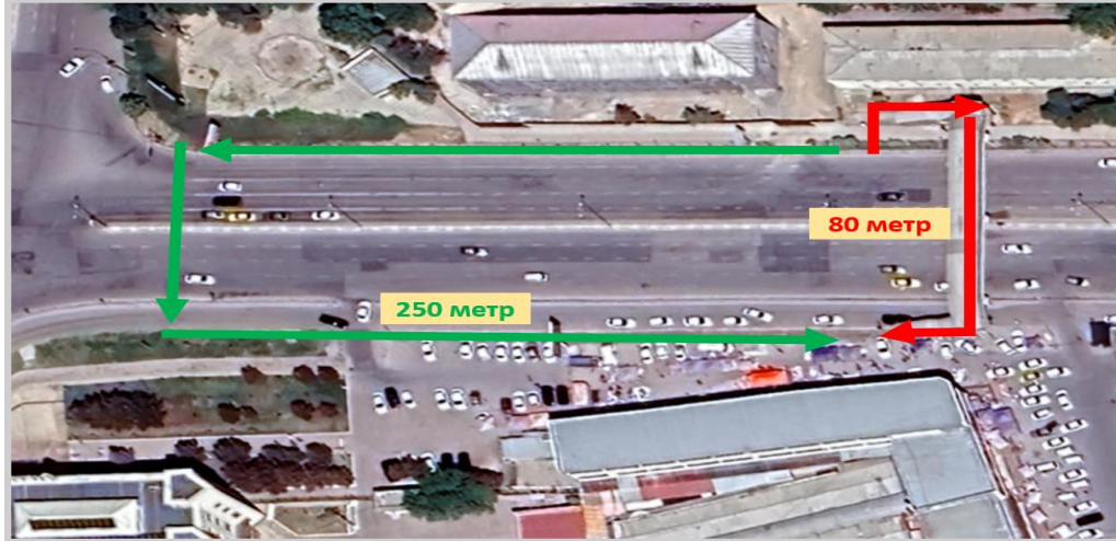
8-rasm. Xonobod ko'chasidan bozor hududiga yer usti va svetofor orqali o'tish yo'llari.
