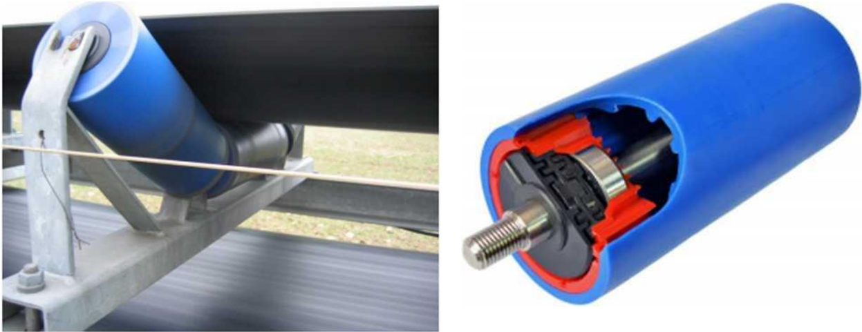
Рис.2 - Роликоопора и ролик ленточного конвейера
