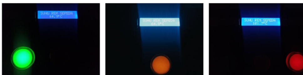
Gambar 5. Hasil Nyala Lampu LED Sesuai Set Point Suhu Pada Sistem
