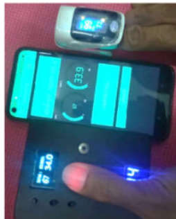
Gambar 14. Hasil Pembacaan Sensor MAX30100 dengan alat standard
