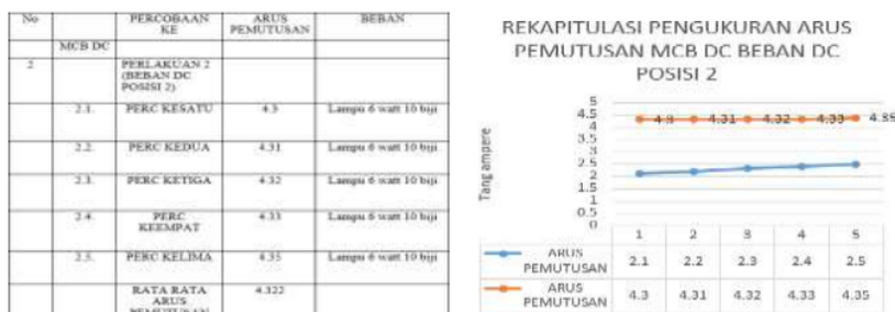
Gambar 4. Rekapitulasi Pengukuran Arus Pemutusan MCB DC Beban DC Posisi 2
