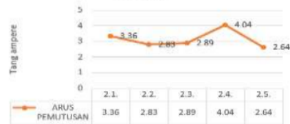
Gambar 8. Rekapitulasi Pengukuran Arus Pemutusan MCB AC Beban AC Posisi 2
