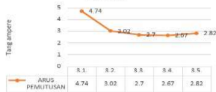
Gambar 9. Rekapitulasi Pengukuran Arus Pemutusan MCB AC Beban DC Posisi 1
