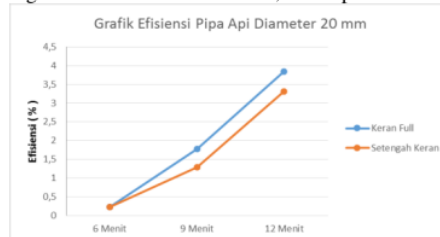
Gambar 4.8 Grafik efisiensi pipa api diameter 20 mm.
