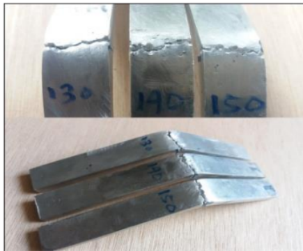
Gambar 6. Spesimen las TIG setelah uji bending.
