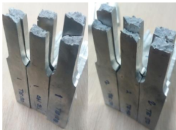
Gambar 10. Spesimen las TIG setelah uji tarik
