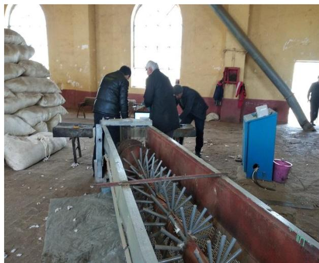
**Рис.1б Усовершенствованный шнековый рабочий орган**
