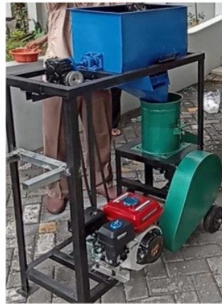
Gambar 2. Mesin pelet pakan ikan dua fungsi
