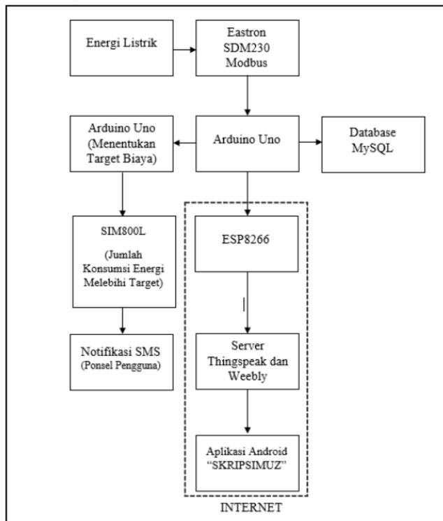
Gambar 1. Diagram Blok Sistem
