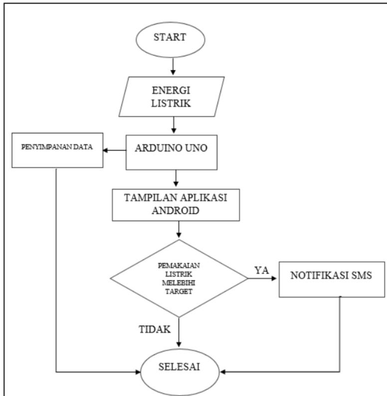
Gambar 2. Diagram Alur atau Flowchart Sistem
