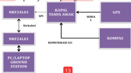
Gambar 2 Diagram Blok Umum Model Kapal Tanpa Awak
