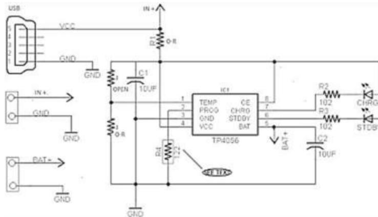
Gambar 5. Rangkaian DC ke DC Konverter IC TP4056 [4]
