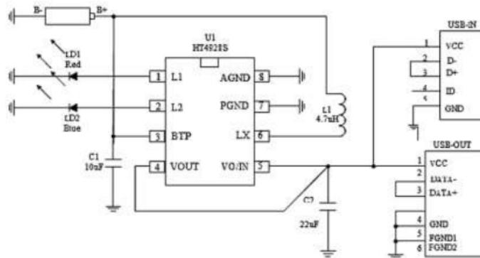
Gambar 6. Rangkaian Penguat DC Boost USB IC HT4928S[5]
