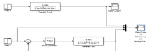
Gambar 7. Open Loop dan Close Loop transfer function
