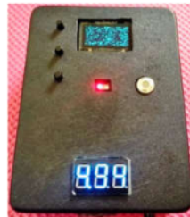
Gambar 10. Rancang Bangun alat monitoring kondisi suhu tubuh dan jantung berbasis IoT
