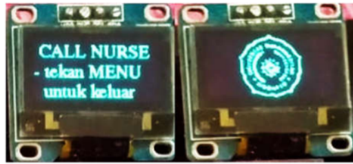
Gambar 3. Bentuk fisik OLED 128x64.
