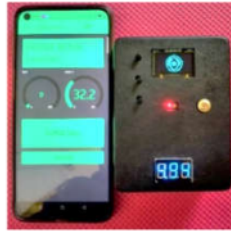
Gambar 13. Hardware alat terhubung dengan aplikasi Blynk
