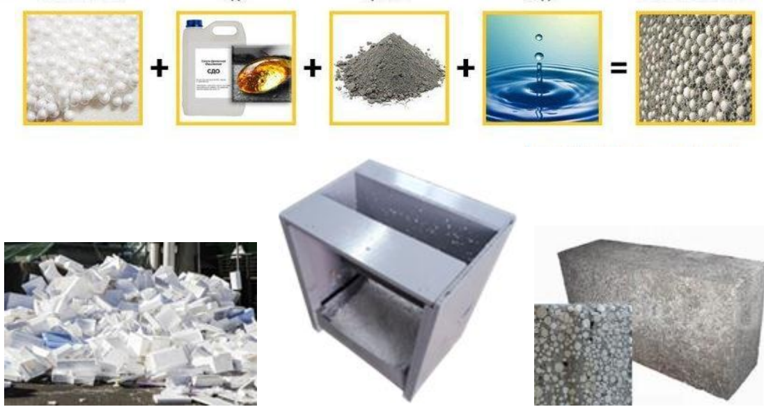
1-rasm: polistrol betonni sanoat chiqindilaridan olish texnologik sxemasi
